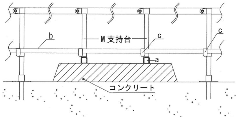
a はコンクリートに固定しない。b のパイプを c の補強金具で支柱に取付ける。
