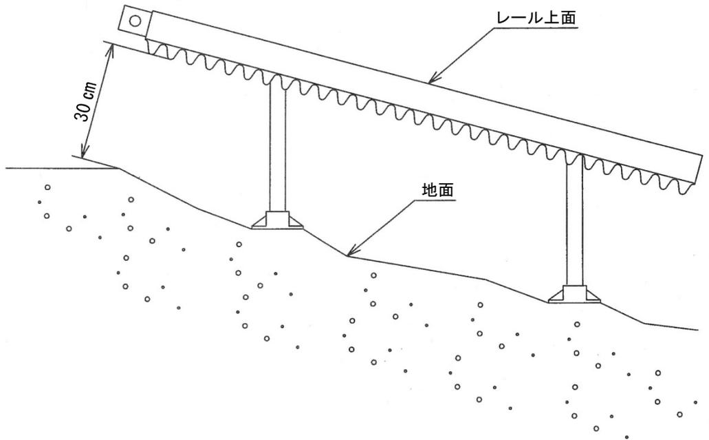
8. 設置最大傾斜角度 (図 16)
