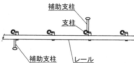
(2) レール上面から地上高 50cm 以上 1m 以内では、全支柱に補助支柱を設置する。
