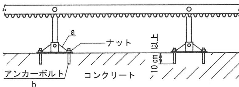
aをbのアンカーボルトとナットで固定する。ボルト穴の深さは10cm以上の深さとする。アンカーボルトまたはケミカルアンカーを使用する。(使用アンカーに決められた穴を開ければ緩まない。)
