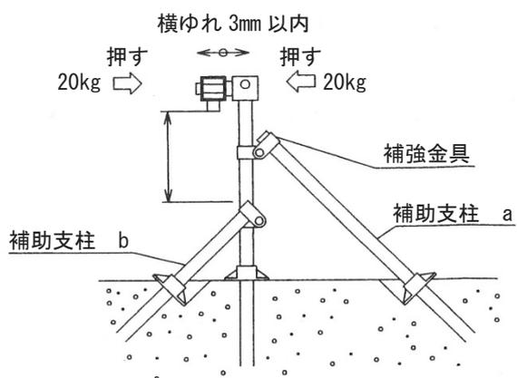
5-2. 補助支柱設置方法 (図 10-1~図 12-2)
