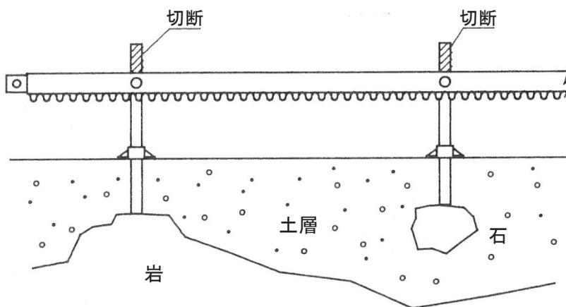
(2) 岩盤に直接支柱を取付けるときはハンマードリルで穴を開け、支柱を打込む。
