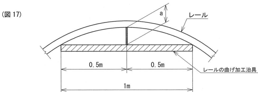
レール左右曲げの傾斜地での a 寸法は表 1 を参照する。
