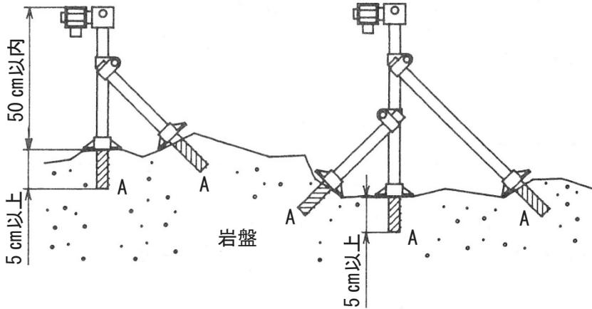
(図 23-1)A、(図 23-2)A の堀削穴は 5cm 以上の深さとする。
