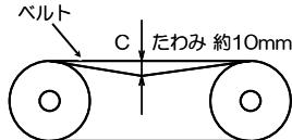
Vベルトがひび割れたり切れたりしているときは、ベルトを交換してください。(次項参照)
