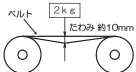
Vベルトがひび割れたり切れたりしているときは、ベルトを交換してください。(次項参照)
