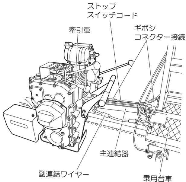
(6) 連結ピンのRピンが破損、または抜けていないか。
