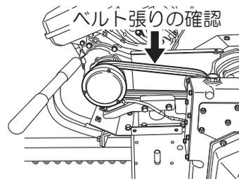
Vベルトがひび割れたり切れたりしているときは、ベルトを交換してください。(次ページ参照)
