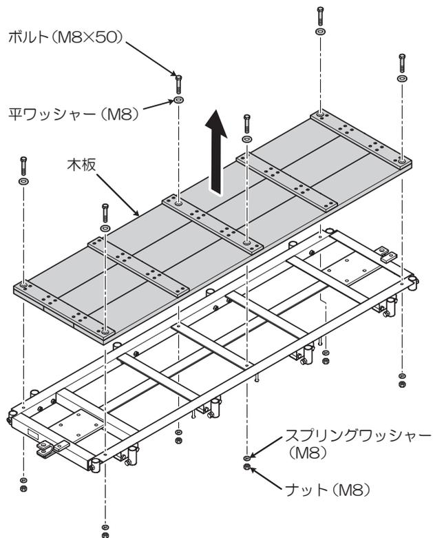
② ボルト、ナットでローラーを組み付けます。
