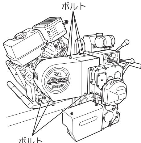
**②** ベルトの張りおよび状態の確認をします。
