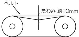
ベルトがひび割れたり切れたりしているときは、ベルトを交換してください。(次項参照)
